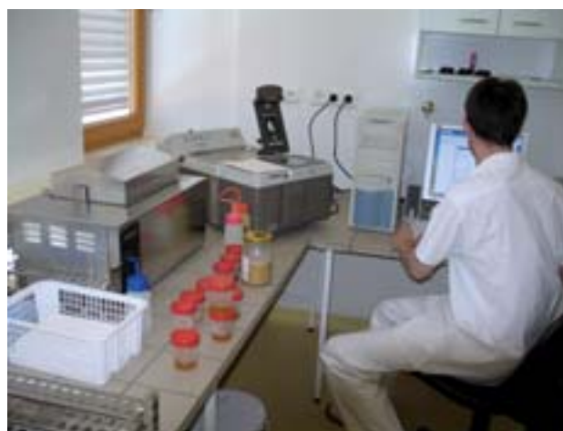
■ Analýza medu pomocí FT NIR spektrometrie
