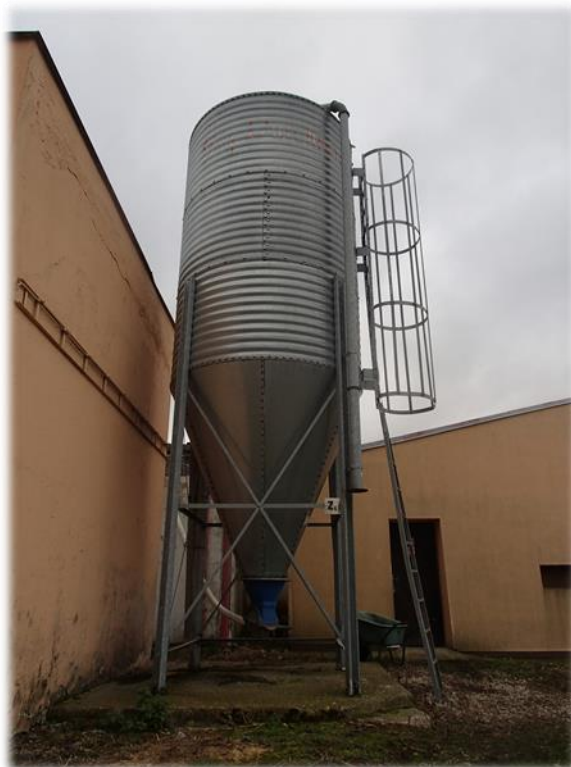
Fotografie č. 65: Silo pro samovolné vyprazdňování doplňkové krmné směsi (autoři, 2019)
