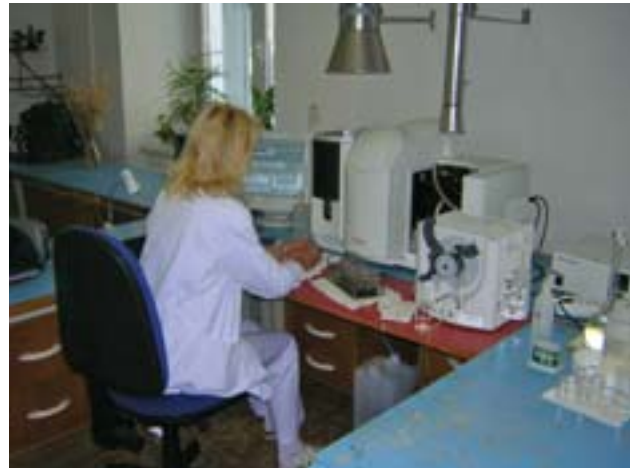
■ Stanovení selenu atomovou absorpční spektrofotometrií
