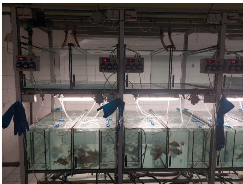
Obrázek č. 1. Průtočný systém pro provádění testů toxicity na kapru obecném (foto: Blahová)
