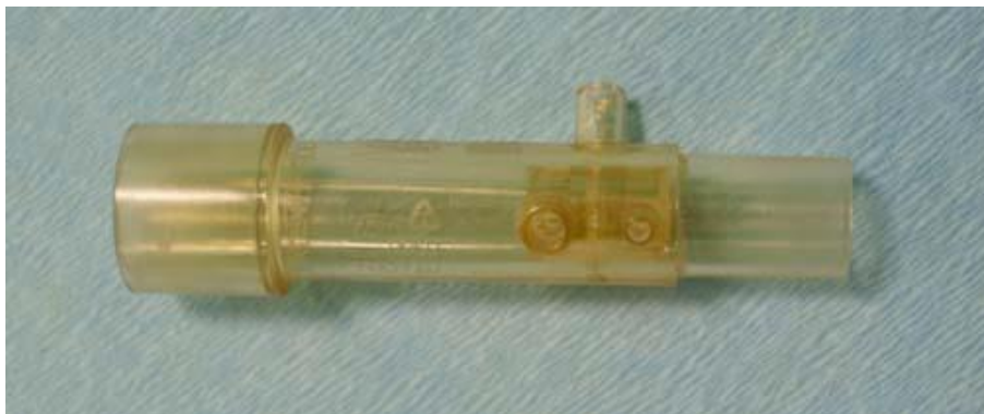
Obrázek 22: Spirometrická koncovka s Pitotovou trubicí a konektory pro spirometrii (2x) a pro kapnografii (1x)
