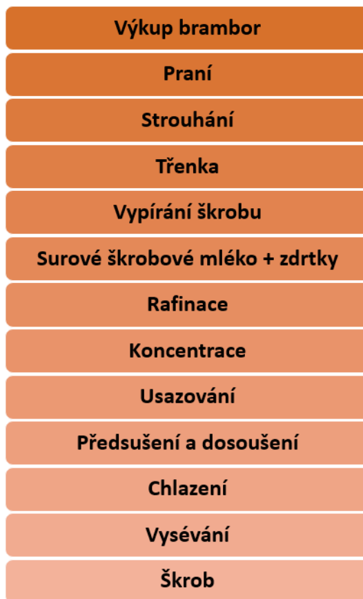
Obrázek č. 1: Schéma výroby bramborového škrobu (Hromčíková, 2023)
