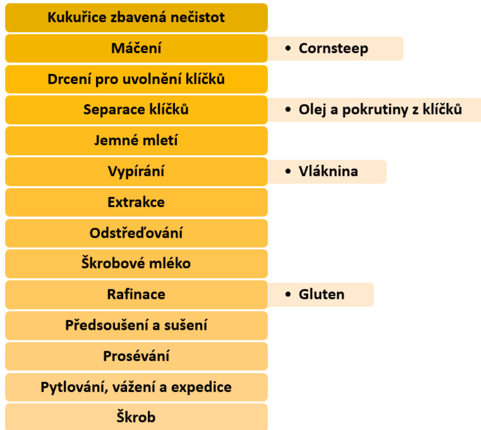
Obrázek č. 2: Schéma výroby kukuřičného škrobu (Hromčíková, 2023)
