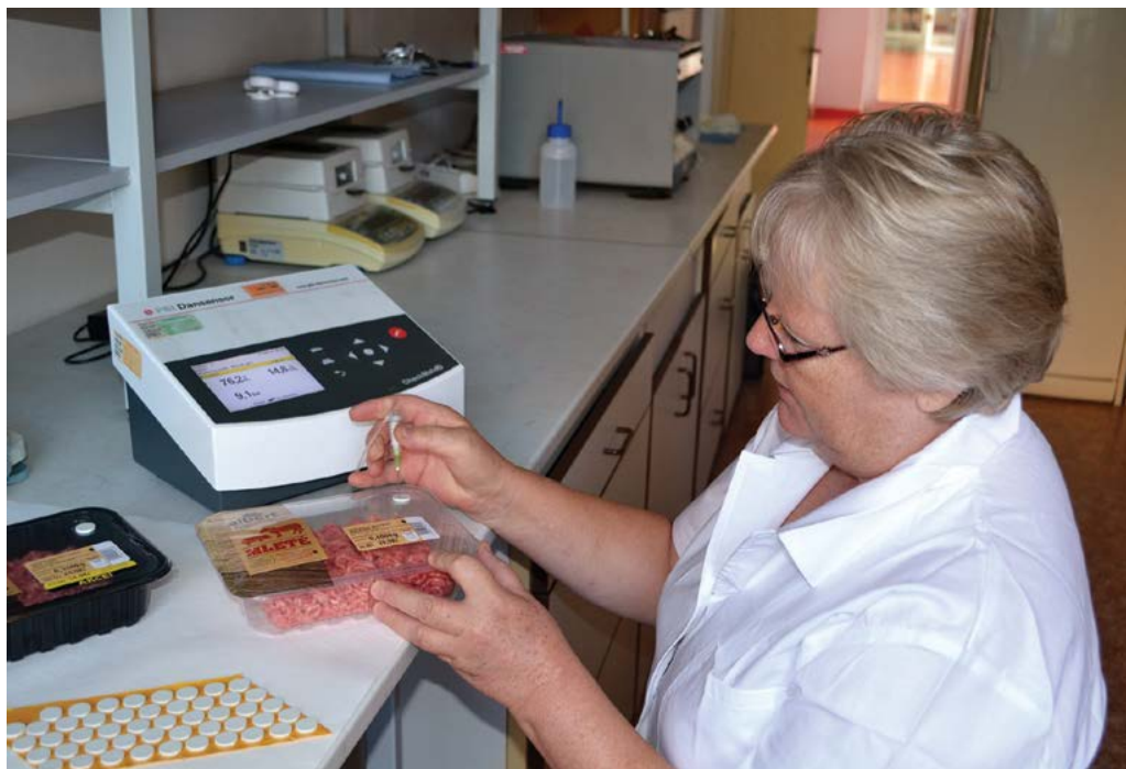
Výzkum na fakultě - analýza směsi plynů masa baleného do modifikované atmosféry
