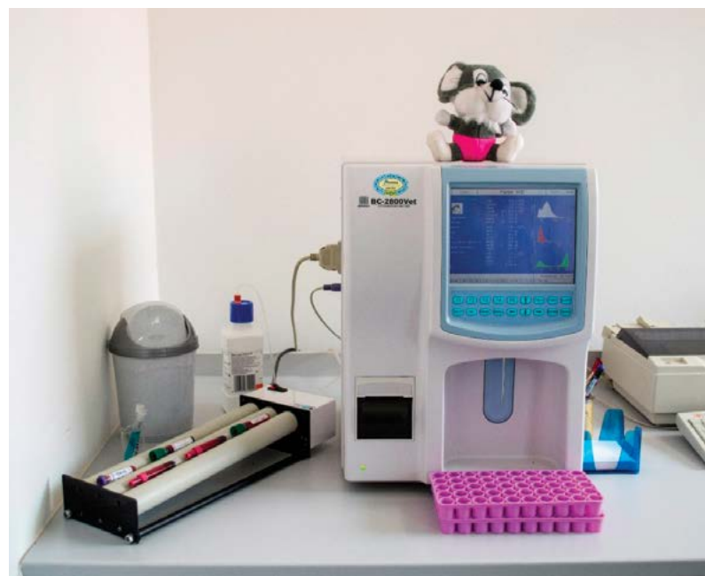
Hematologická laboratoř. Automatický hematologický analyzátor BC-2800 VET, Mindray.
