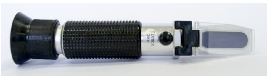
Obrázek 5 Optický refraktometr (Pišťková K, Danielová L, Illek J 2016: Laboratorní diagnostika u potravinových zvířat-praktická cvičení).
